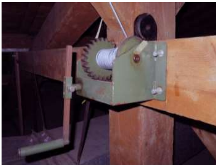
Fig. 138. Système d'élévation des lustres de la salle des fêtes.
